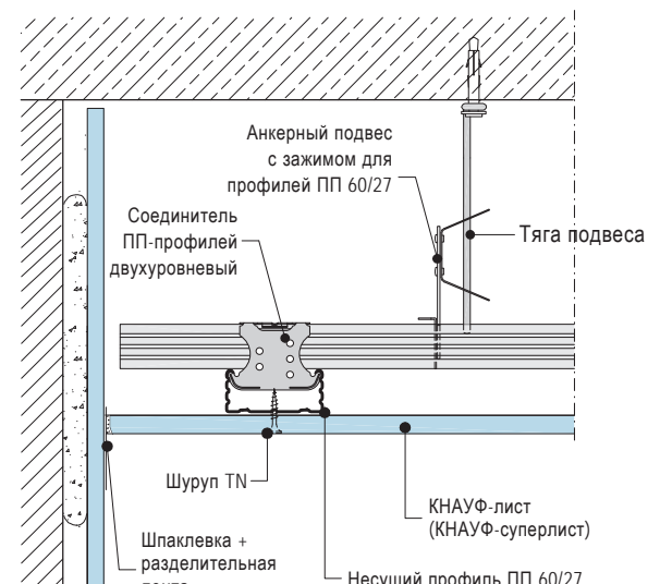
Примыкание к стене
