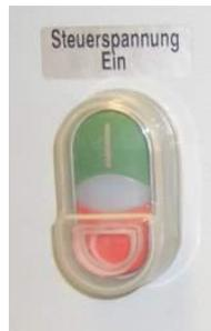
Рис. 64: Кнопка „ВКЛ / ВЫКЛ.“
