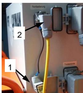
Рис. 44: Подключение дистанционного управления
