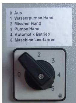
Рис. 13: Переключатель опорожнения смесителя
