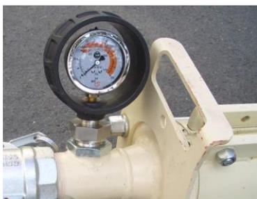
Рис. 38: Манометр давления раствора
