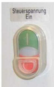
Рис. 66: Кнопка „ВКЛ / ВЫКЛ.“
