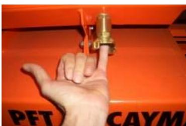
Рис. 70: Обратный клапан
