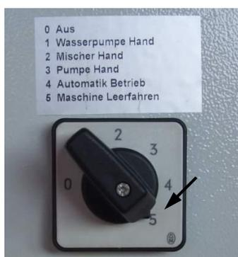
Рис. 54: Опорожнение машины
