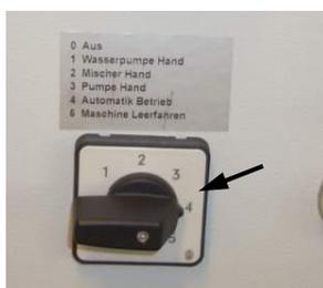
Рис. 39: Автоматический режим работы
