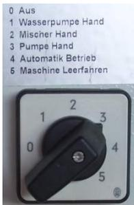
Рис. 71: Насос в ручном режиме
