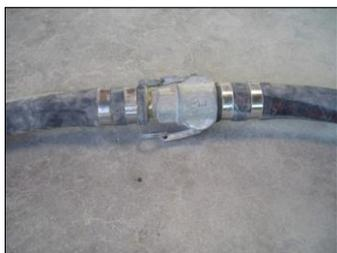
Рис. 51: Размыкание муфтовых соединений
