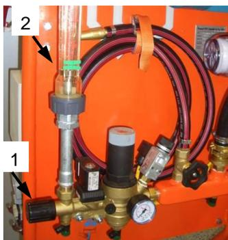
Рис. 41: Регулировка консистенции раствора
