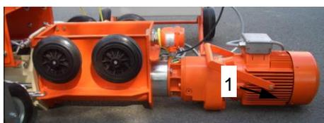
Рис. 14: Съем насосного узла
