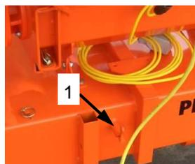
Рис. 19: Открыть поворотный фиксатор
