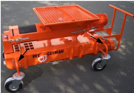
Рис. 16: Транспортировка краном
