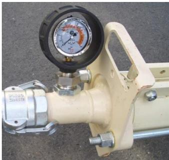
Рис. 35: Манометр давления раствора
