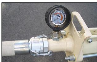
Рис. 52: Манометр давления раствора
