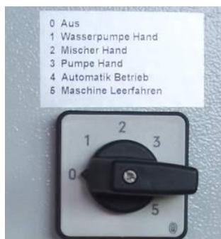
Рис. 8: Переключатель в положении «0»
