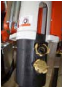
Рис. 64: Очистка резиновой смесительной камеры
