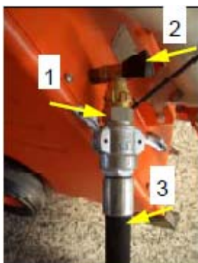
Рис. 40: Подготовка шланга для раствора
