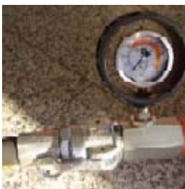
Рис. 74: Манометр давления раствора
