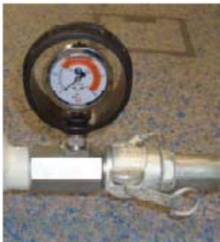
Рис. 35: Манометр давления раствора
