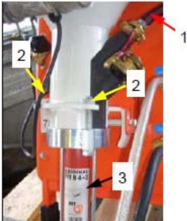
Рис. 63: Снятие насосной установки
